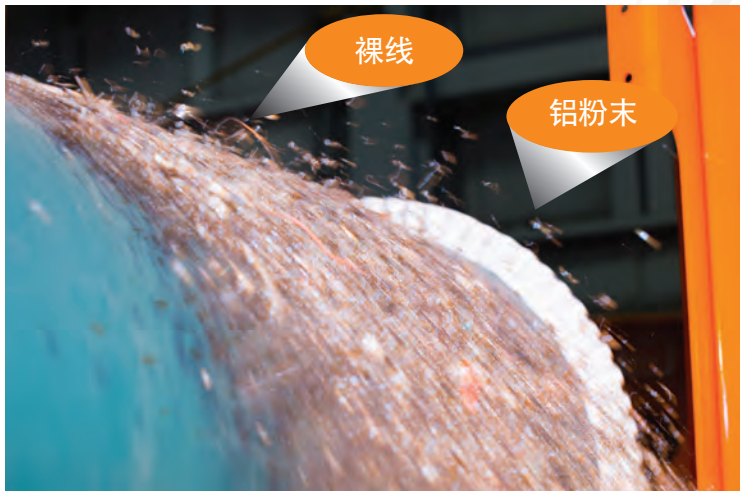
▲ 超高频涡流分拣机能够回收裸线和铝粉末
