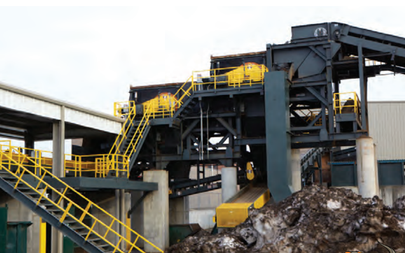
▲ P-Rex筒除铁机在潜流铁工艺中运行。
